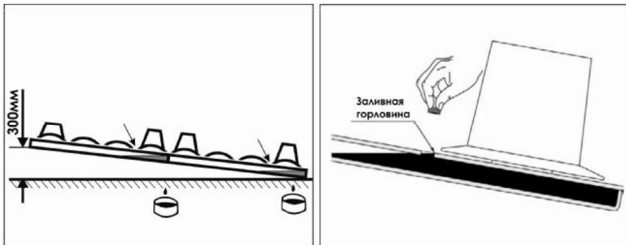
Рисунок 7.3 - Проверка уровня масла в режущих брусах
