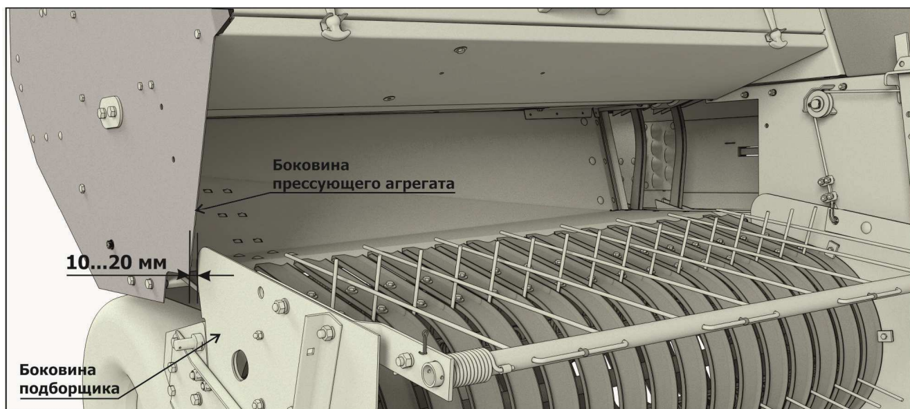
Рисунок 5.3 – Установка подборщика
