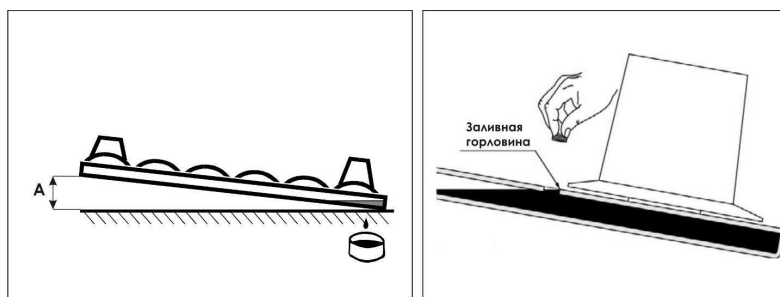
Рисунок 7.3 - Проверка уровня масла в режущем аппарате
