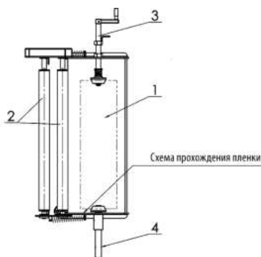
1-ролик пленки; 2-алюминевый валик; 3-винт регулировочный; 4-конус поддерживающий
