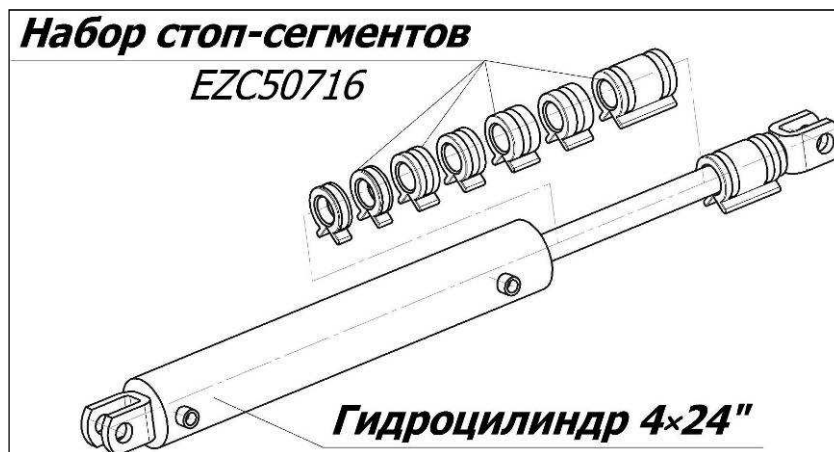
Рисунок 6.2 – Установка стоп-сегментов EZC50716 на шток гидроцилиндра
