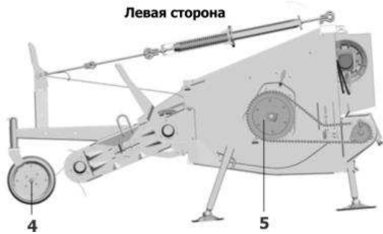
Рисунок 6.1 – Объекты смазки платформы-подборщика
