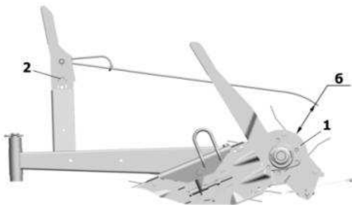
1 – Задний вал транспортера; 2 – Упор
