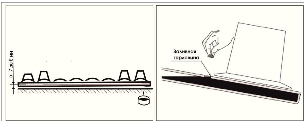
Рисунок 8.3 - Проверка уровня масла в режущем аппарате
