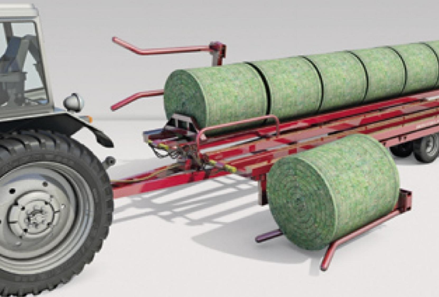
Прицеп для транспортировки рулона самозагрузочный ТПР 1100 это лучший способ бережного сбора вального урожая. Аккуратный подбор и загрузка рулона проводится вилочным захватом, который с помощью гидроцилиндра поднимает рулон на платформу. Далее передняя стенка передвигает рулон назад. Разгрузка производится методом сдвига рулона передней стенкой через задний гидравлически-открывающийся борт. Они легко скользят по направляющим, сохраняя форму и целостность.
