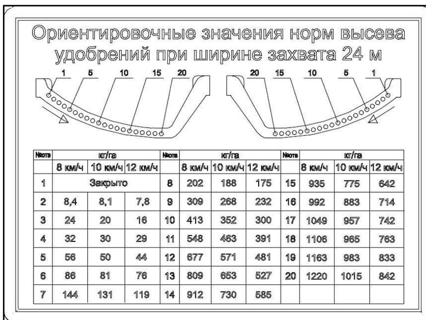
Рисунок 5.7 – Ориентировочные значения норм высева удобрений при ширине захвата 24 м
