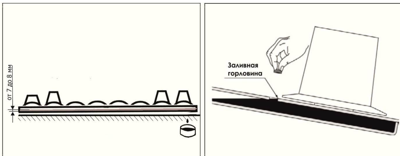
Рисунок 7.5 – Проверка уровня масла в режущем аппарате
