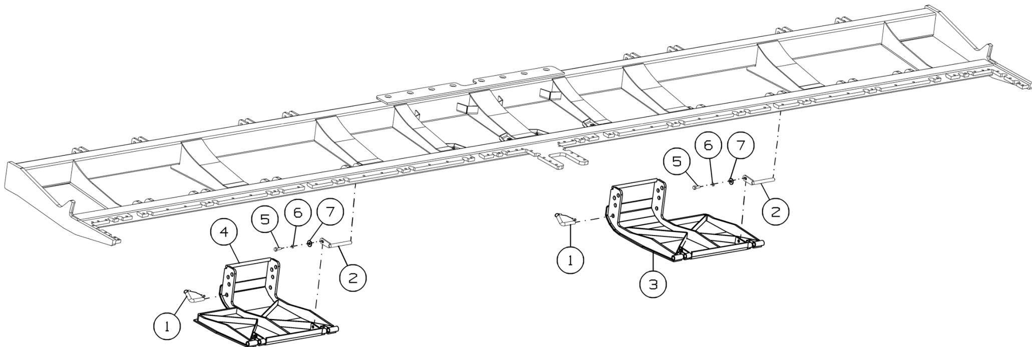
Рисунок 14 - Установка башмаков центральных регулируемых ЖРН-604.04.04.000А
