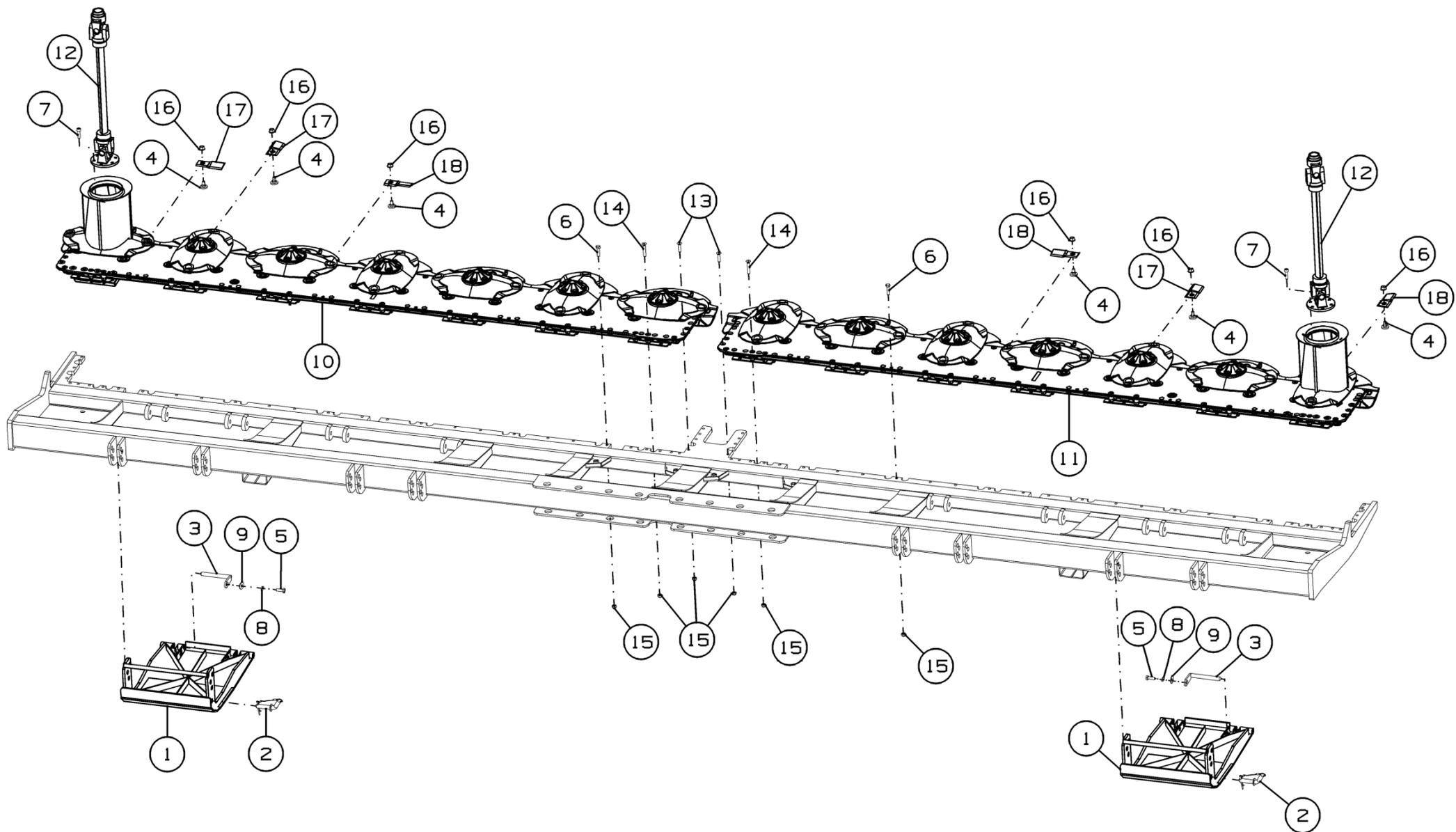
Рисунок 11 - Установка брусьев режущих и башмаков ЖРН-604.04.01.000А
