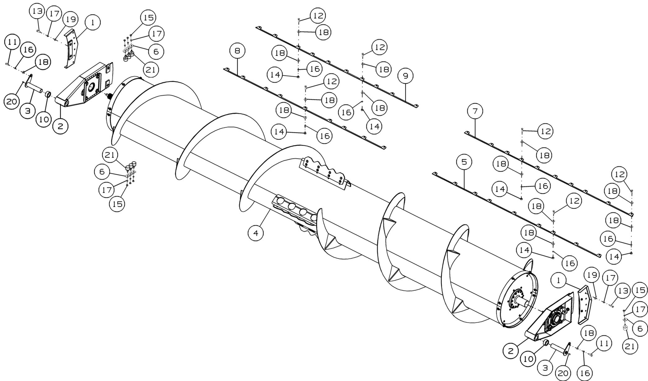
Рисунок 7 - Установка шнека ЖРН-604.03.00.000А
