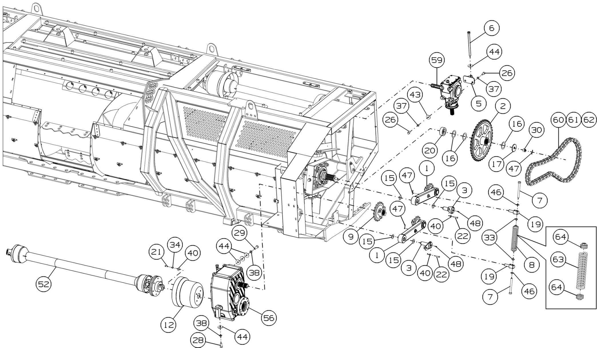
Рисунок 3 - Установка приводов ЖРН-560.06.00.000
