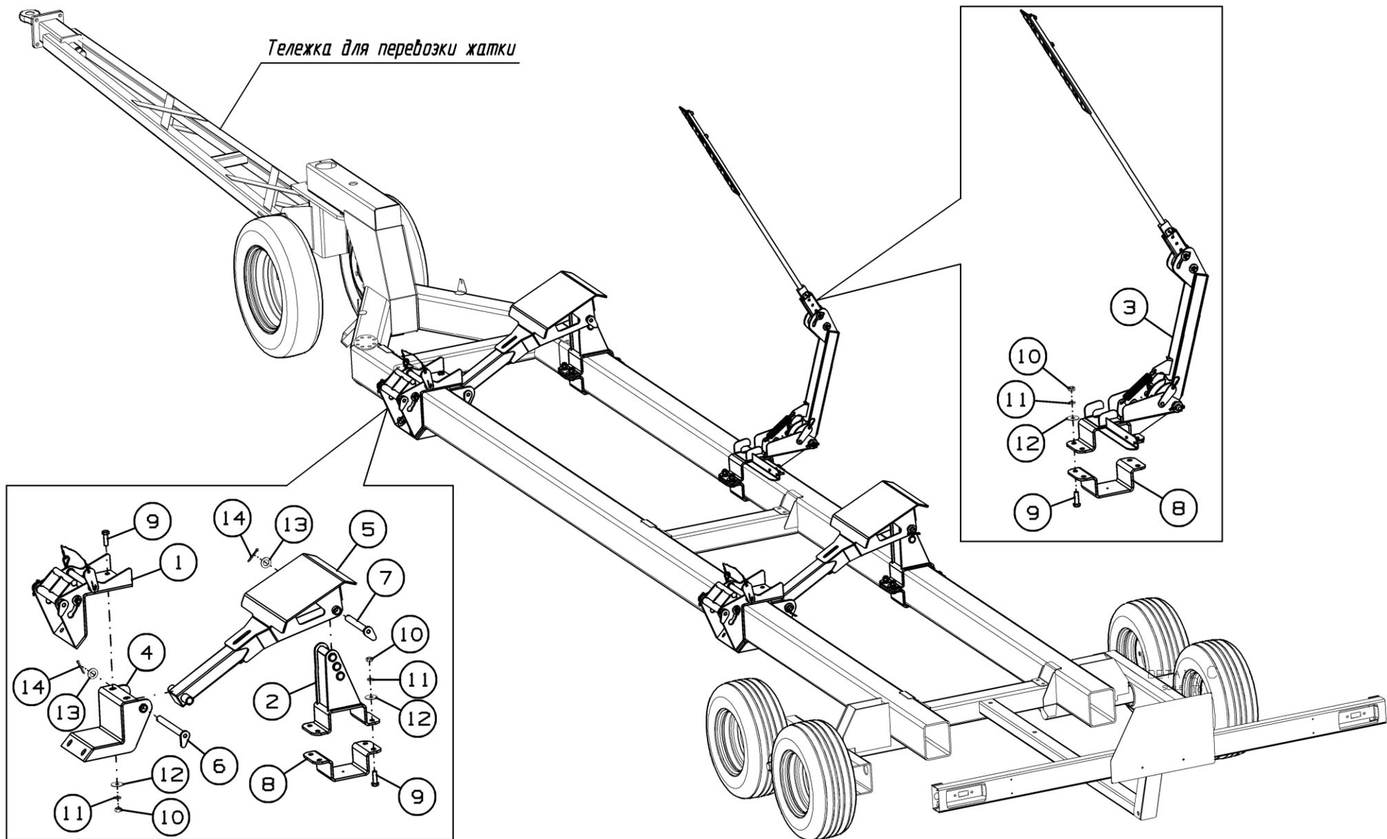
Рисунок 41 - Комплект переоборудования тележки для перевозки ЖРН-605 ЖРН-605.13.00.000А
