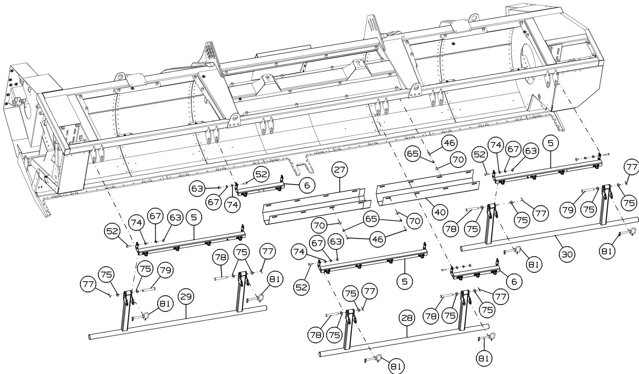
Рисунок 19 - Установка щитов ЖРН-560.10.00.000
