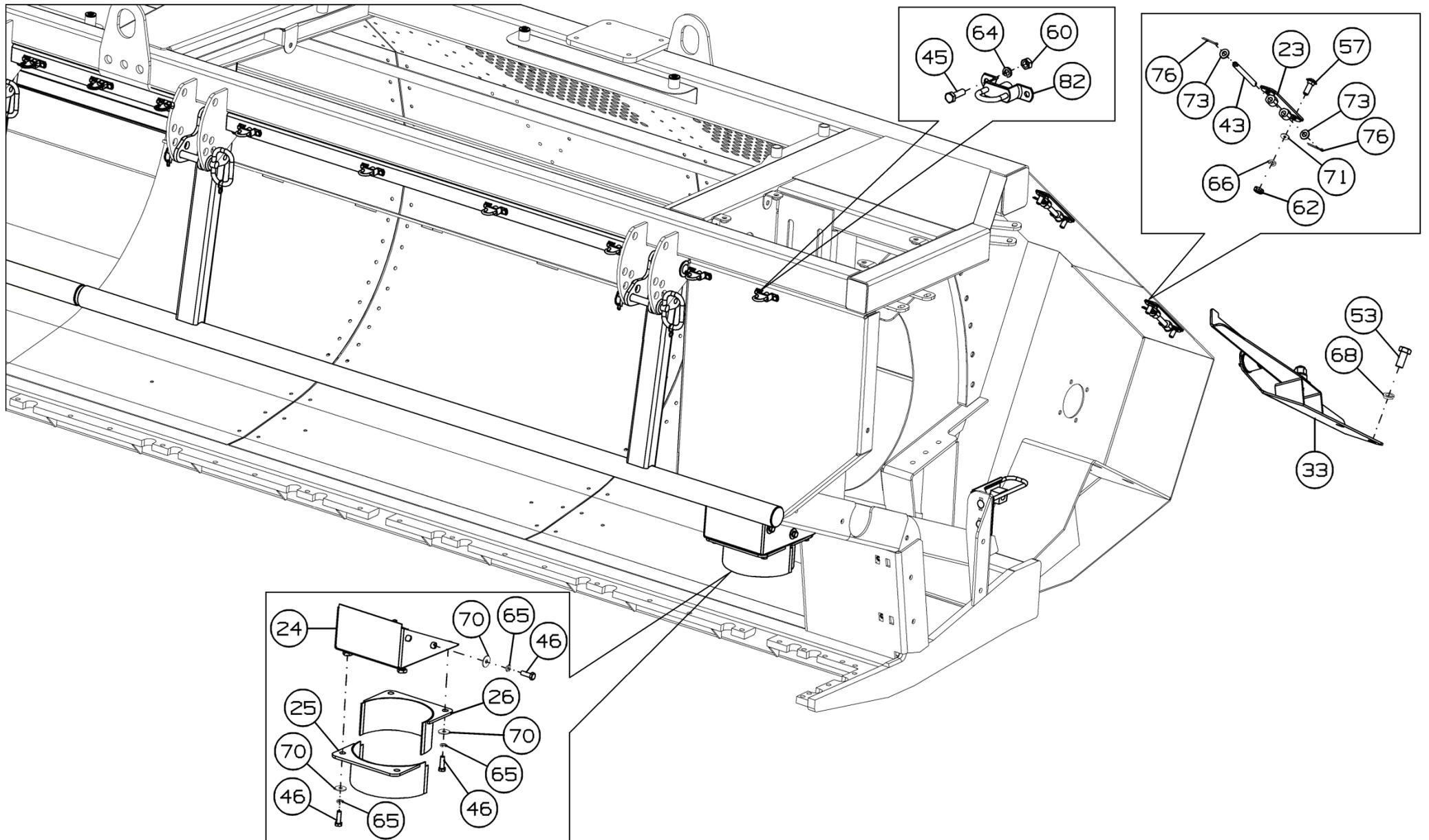
Рисунок 18 - Установка щитов ЖРН-560.10.00.000
