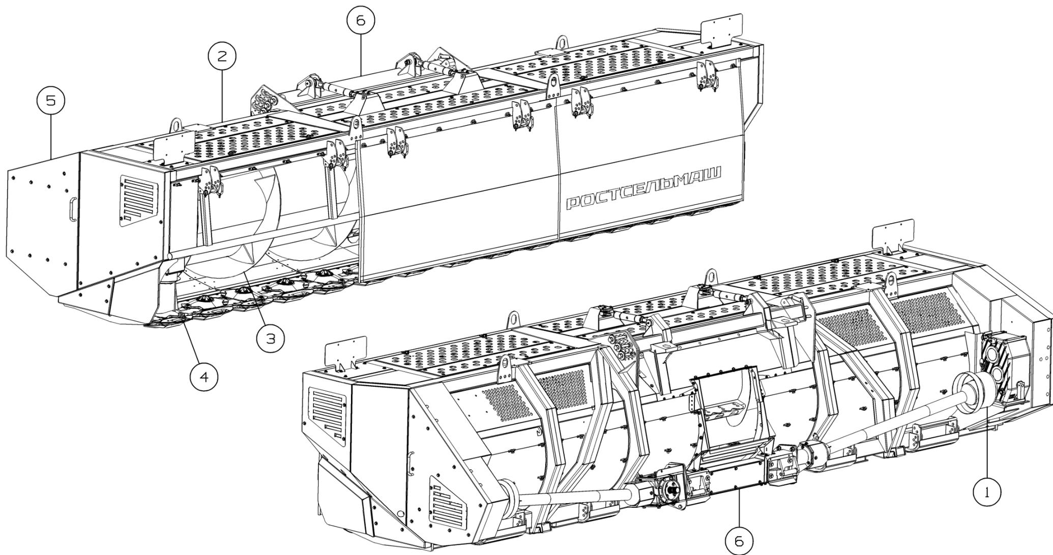
Рисунок 1 - Жатка роторная навесная "Grass Header 600" ЖРН-560.00.00.000 и ЖРН-560.00.00.000-01
