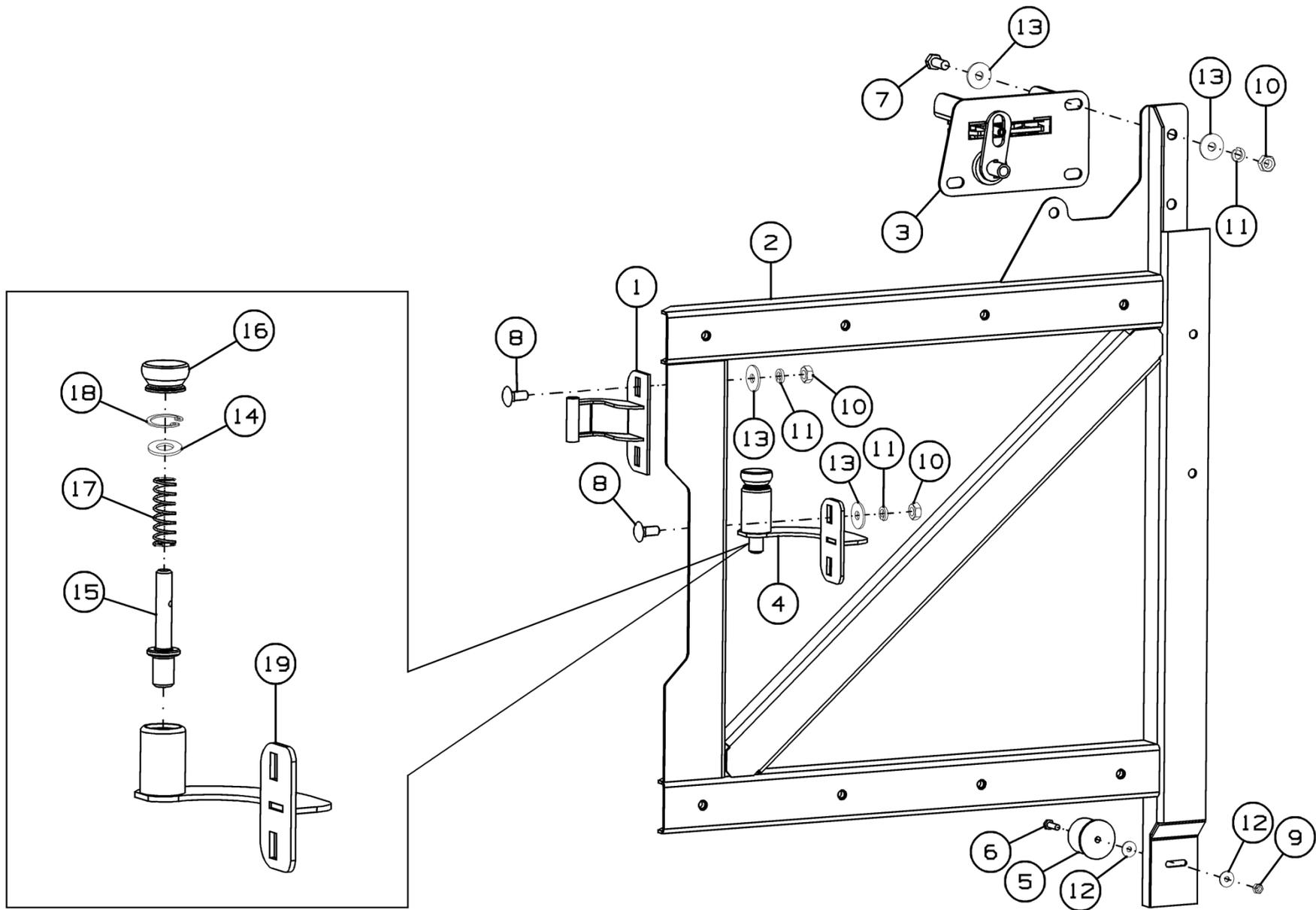
Рисунок 27 - Каркас щитка ЖРН-604.10.00.120А
