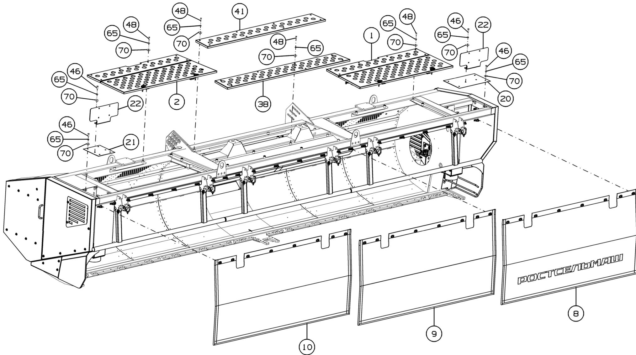
Рисунок 15 - Установка щитов ЖРН-560.10.00.000
