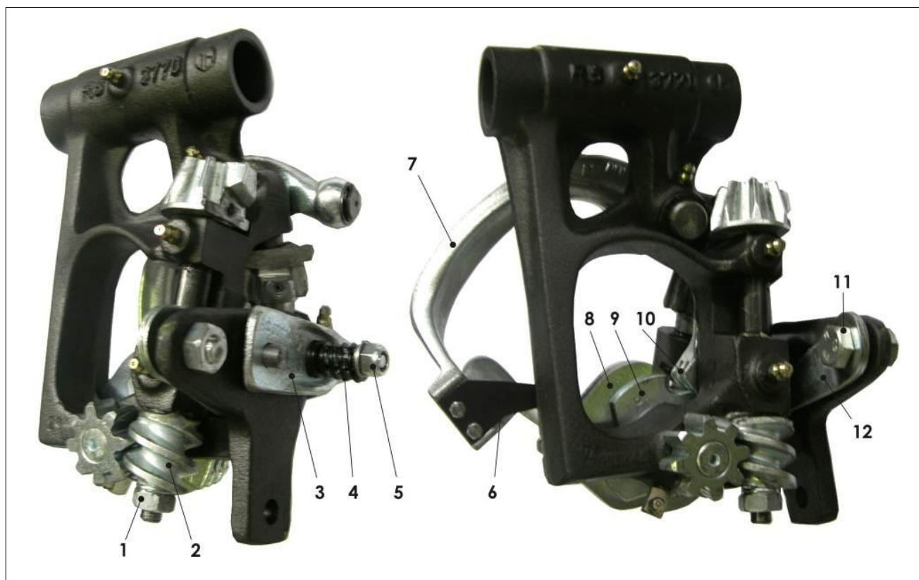
1 – Гайка; 2 – Червяк; 3 – Замыкатель; 4 – Пружина; 5 – Гайка; 6 – Нож; 7 – Ножевой рычаг; 8 – Очиститель; 9 – Двойной диск; 10 – Держатель шпагата; 11 – Болт; 12 – Рычаг
