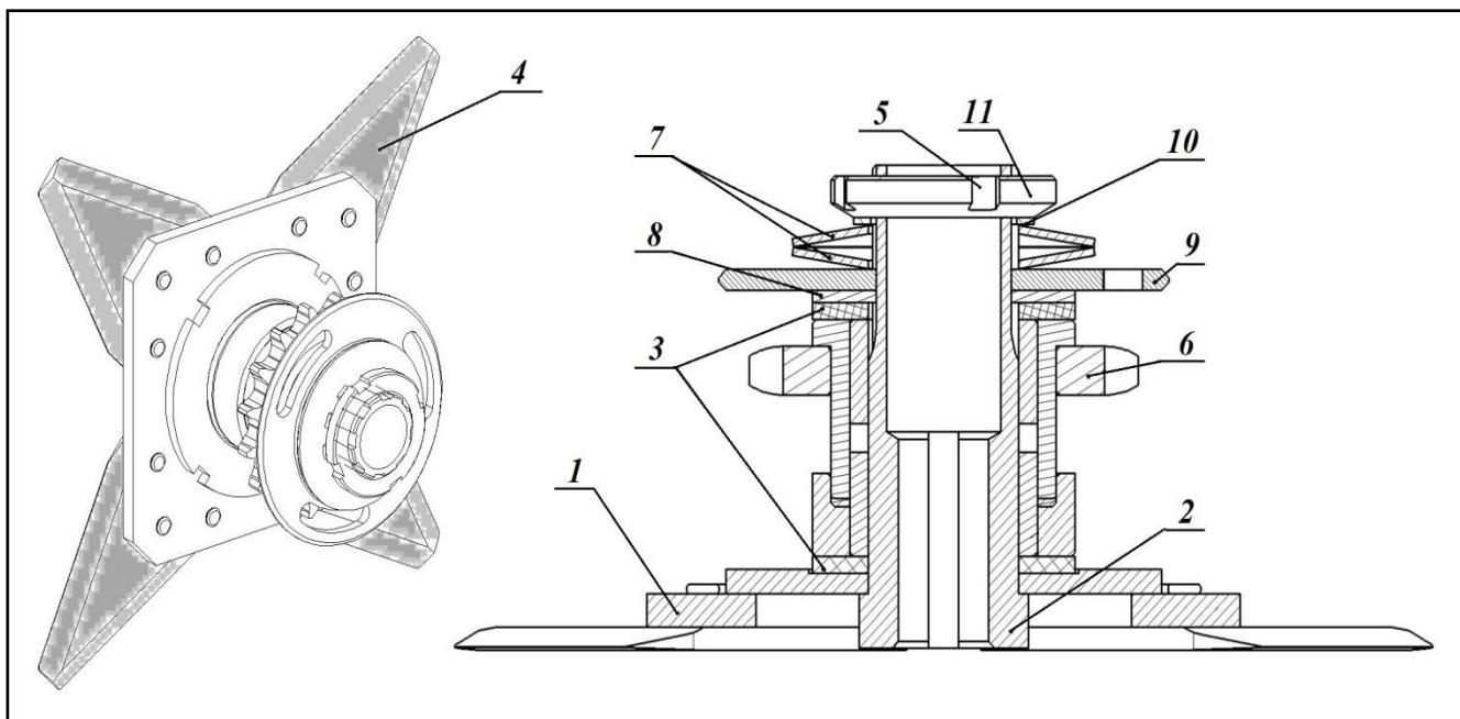
1 – Диск ножевой; 2 – Втулка шлицевая; 3 – Фрикционная накладка; 4 – Нож; 5 – Шайба стопорная;
