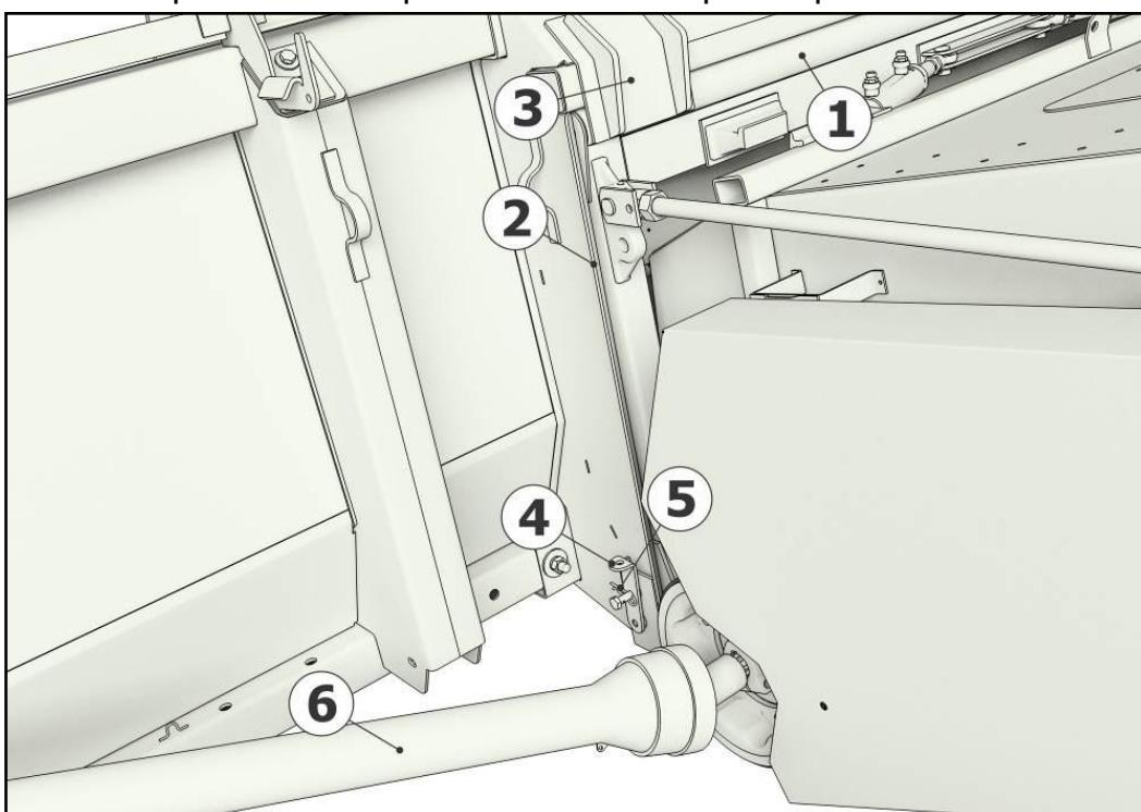
1 – Верхняя труба наклонной камеры; 2 – Ловитель жатки; 3 – Зацеп; 4 – Фиксатор; 5 – Шплинт;
