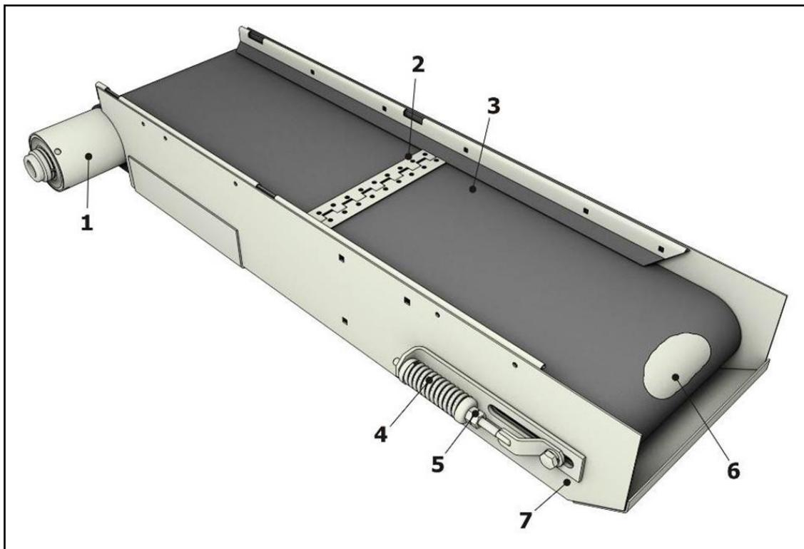
1 – Ведущий валик; 2 – Шарнирная петля; 3 – Прорезиненная лента; 4 – Пружина;
