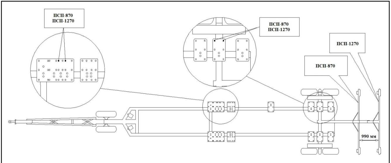
Рисунок 9.3 – Установка опор приспособления ПСП-870
