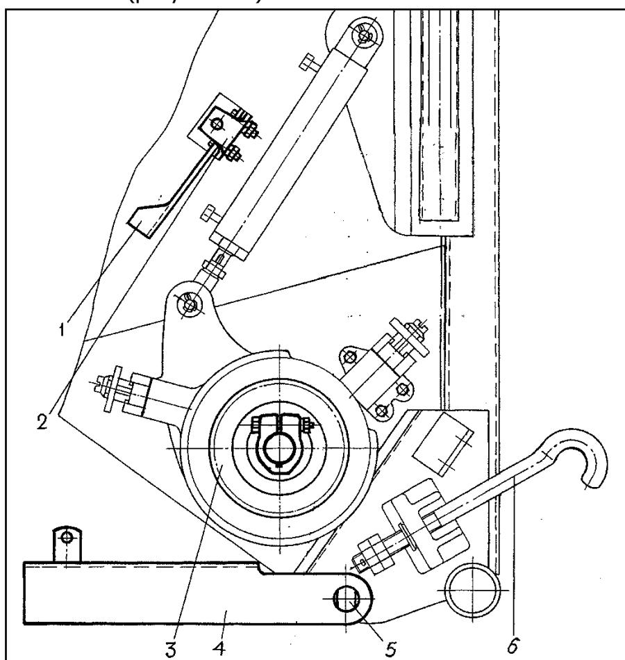
1 – Кронштейн; 2 – Кронштейн; 3 – Звездочка; 4 – Упор; 5 – Натяжное устройство; 6 – Ось
