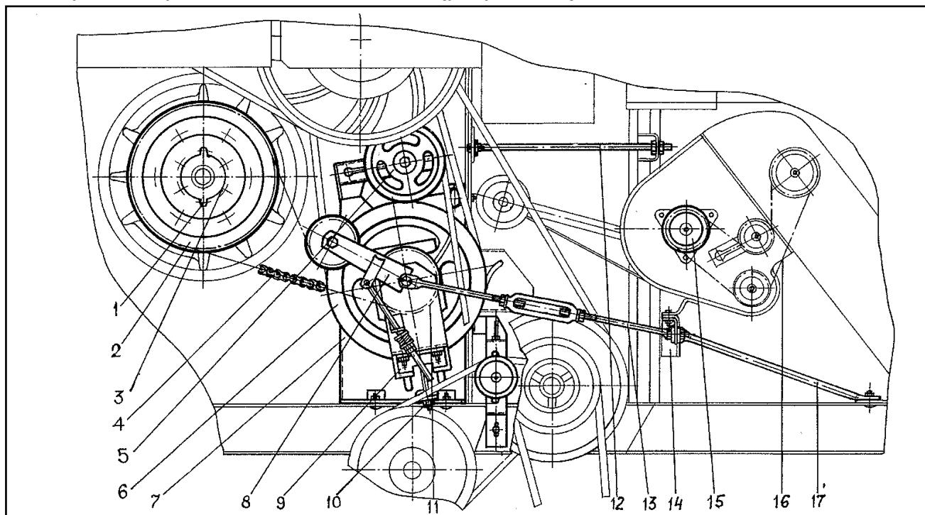
1 – Болт; 2 – Звездочка; 3 – Болт; 4 – Цепь; 5 – Шкив натяжной; 6 – Шкив привода; 7 – Плита; 8 – Рычаг; 9 – Ползун; 10 – Винт регулировочный; 11 – Опора; 12 – Связь; 13 – Растворка; 14 – Кронштейн; 15 – Звездочка; 16 – Цепь; 17 – Связь
