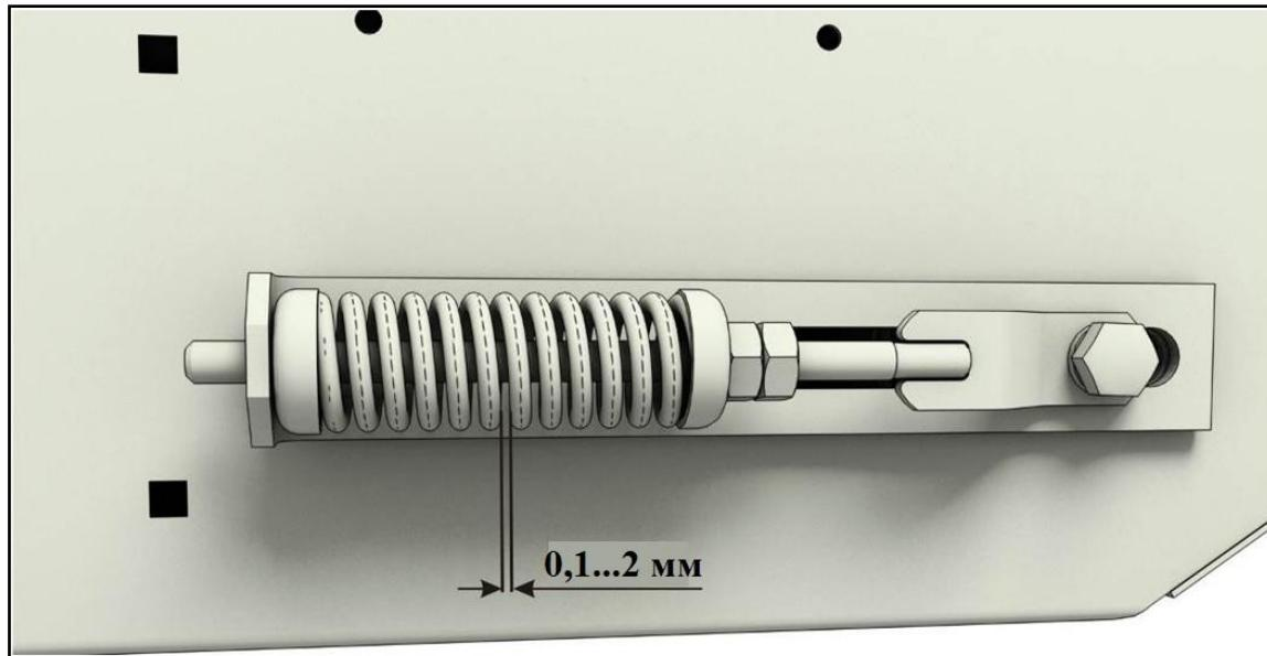
Рисунок 2.13 – Контроль натяжения лент транспортеров семян
