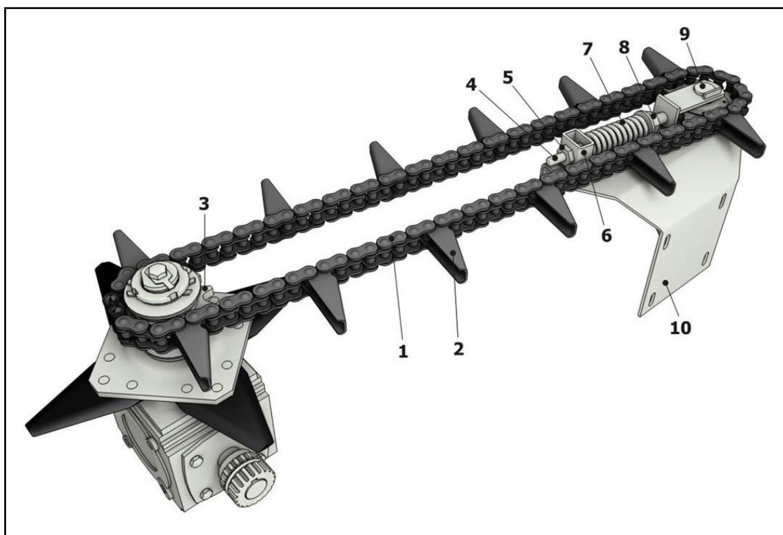
1 – Цепь; 2 – Лапка; 3 – Ведущая звездочка; 4 – Тяга; 5 – Гайка; 6 – Упор; 7 – Пружина;
