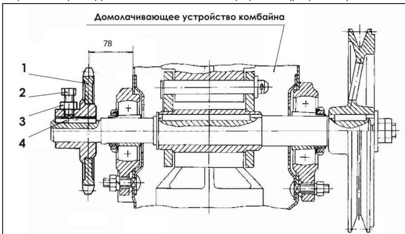
1 – Звездочка; 2 – Стопорный винт; 3 – Гайка; 4 – Шпонка
