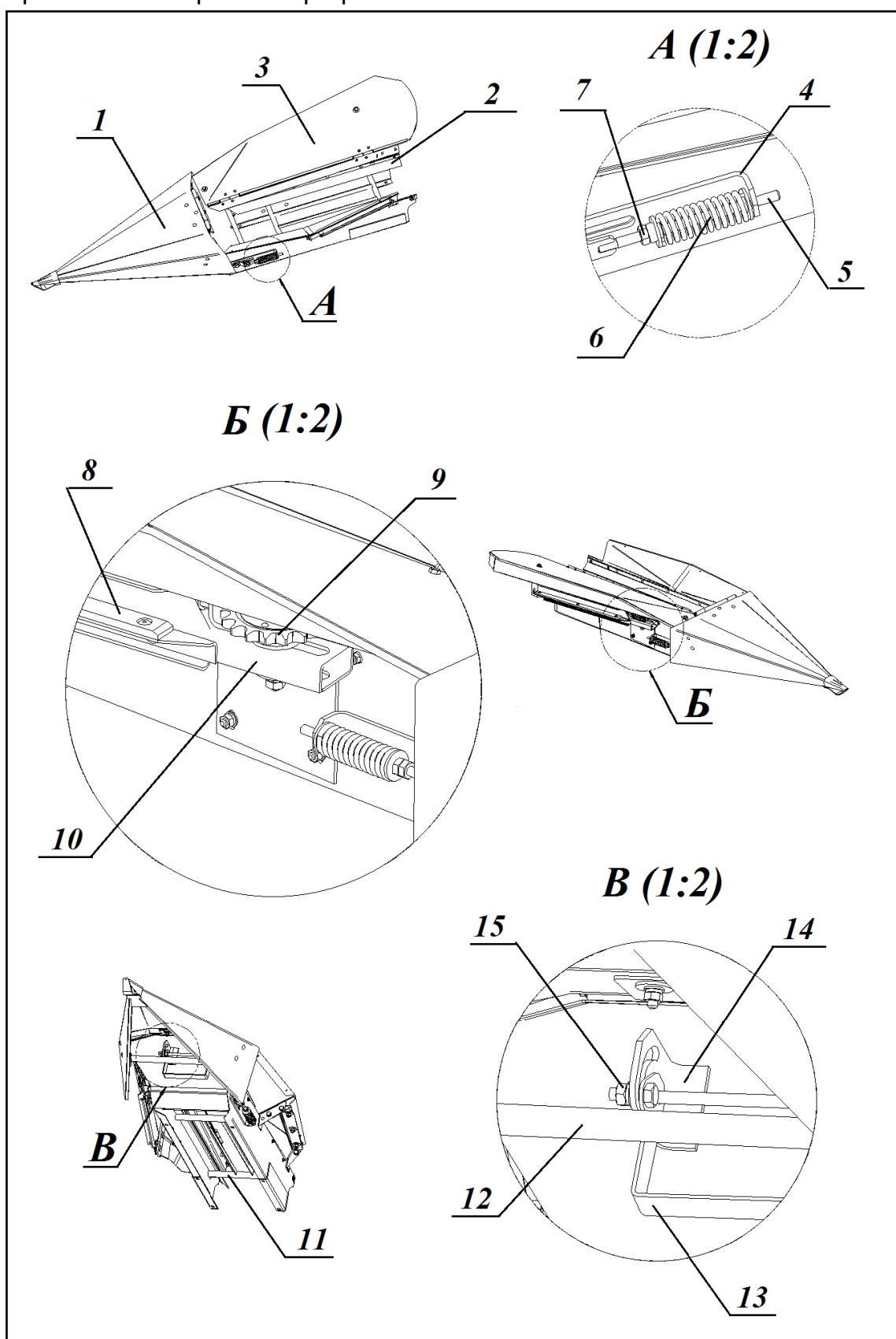
1 – Делитель; 2 – Отлив; 3 – Щиток; 4 – Упор; 5 – Тяга регулировочная; 6 – Пружина;
