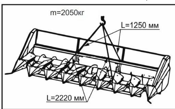
Рисунок 9.1 – Схема строповки
