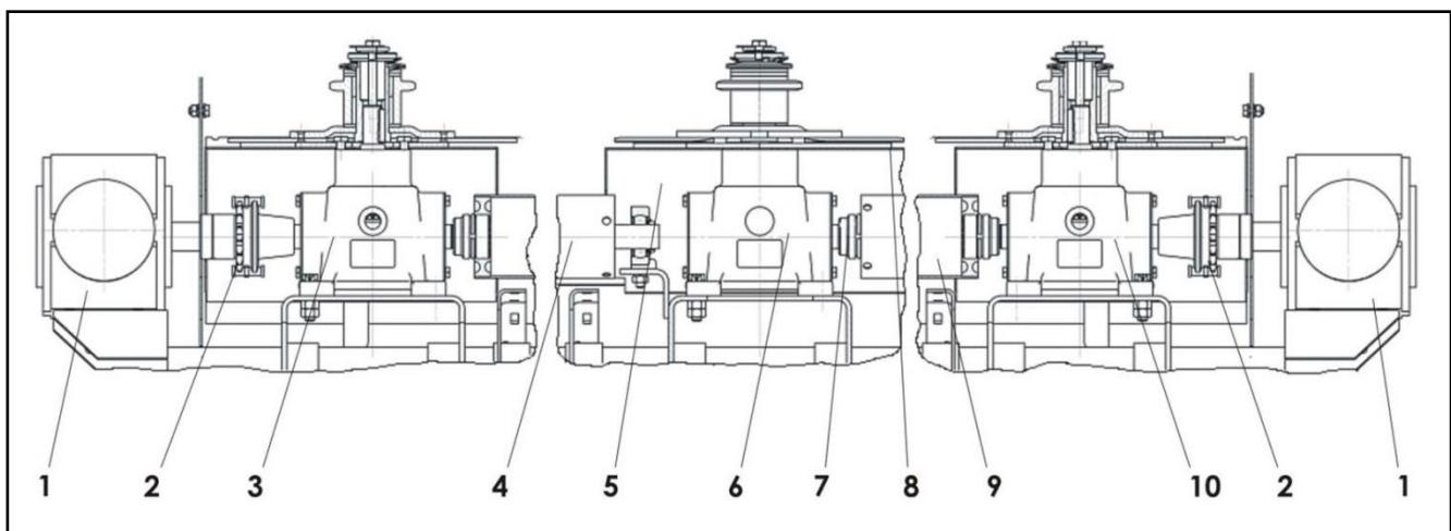
1 – Угловой редуктор; 2 – Цепная муфта; 3, 6, 10 – Конический редуктор; 4 – Валик центральный; 5 – Кожух защитный; 7 – Муфта шлицевая; 8 – Противорежущая пластина; 9 – Валик транспортера семян
