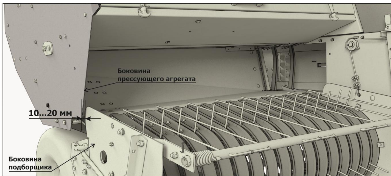
Рисунок 5.4 – Установка подборщика
