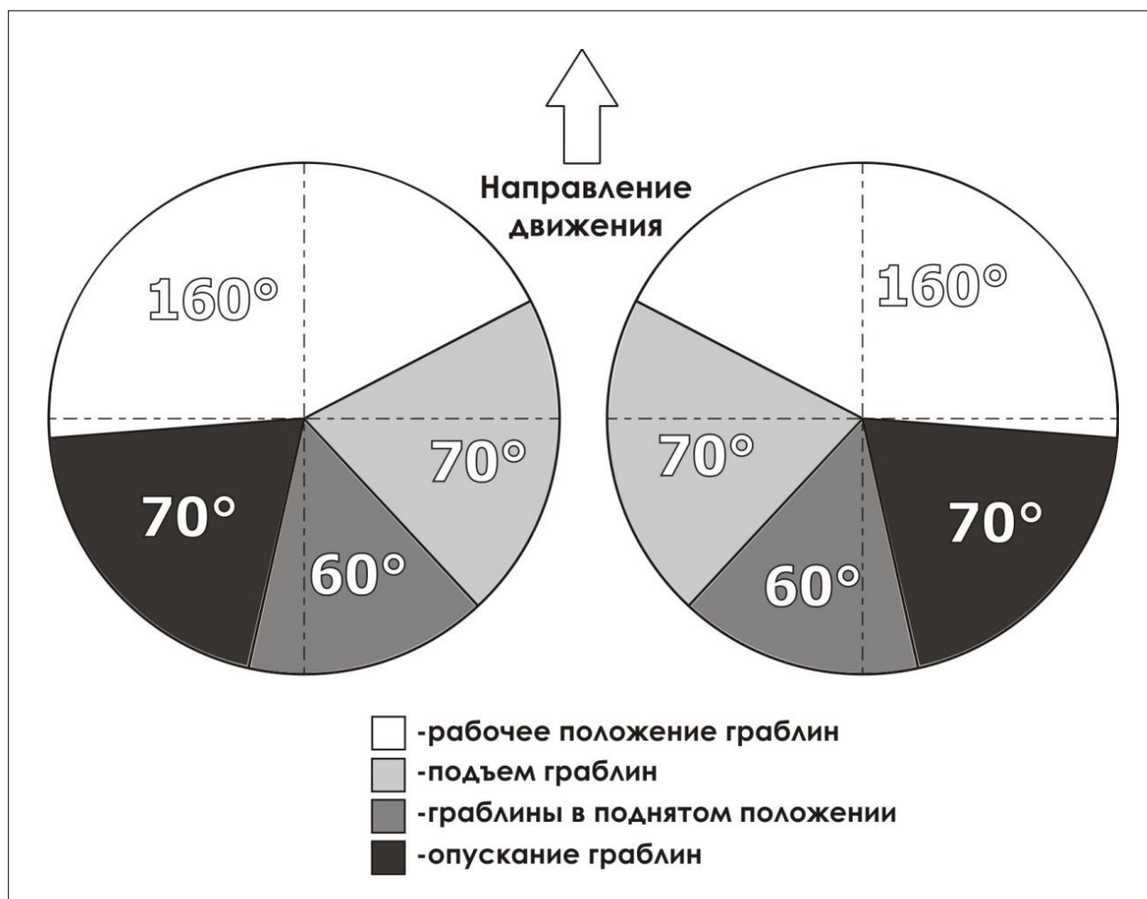
Рисунок 3.3 – Схема работы кольцевых направляющих дорожек редукторов роторов
